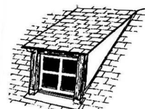
lucarne rampante ou en "chien couché"
